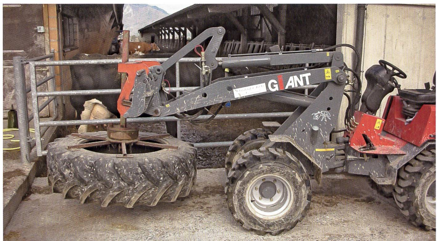
«Hausgemachter» Futtermischwagen mit einem gebrauchten Reifen am Weidemann.
