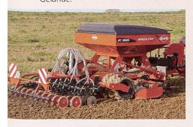
Für den Ackerbau präsentiert Agriott mit der Premia eine neue Generation der mechanischen Sämaschinen mit präzisem Schubradsystem und den Speedliner, eine pneumatische Mulchsämaschine für Bodenbearbeitung und Saatgutablage in einem Arbeitsgang. Die Swiss Top-Pflüge, 3- und 4-Schar, böten breite Furchenausräumung bei geringem Zugkraftbedarf. Für den Stall gibt es den Euromix PLUS, einen vertikalen Futtermischwagen mit integrierter Hochleistungsturbine zum Einstreuen bis 20 Meter.
