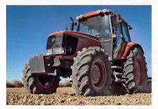
8-fach-Lastschaltung und als technische Besonderheit den Allradantrieb mit Bi-Speed-Lenksystem, das für einen besonders kleinen Wenderadius sorgt.
