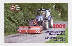
Wird an einem Traktor ein Zusatzgerät vorne angebaut und entsteht dadurch eine Distanz von mehr als 3 Meter von der Mitte der Lenkvorrichtung bis zum vordersten Fahrzeugteil, müssen Seitenblickspiegel angebracht werden. Dies gilt seit 1. Juli 2008 für alle betroffenen Geräte, z. B. Frontlader, Mähwerke, Bandrechen oder Frontpacker.
