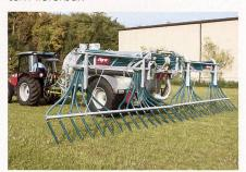
In Transportstellung werden die Ausleger mechanisch und hydraulisch am Fasskörper verriegelt. Zudem sind die Schleppschlauchgestänge bis 12 Meter in Kombination mit einem Agrar-Güllefass mit Metalltank bis zur Grösse von 12 000 Liter nicht breiter als 2,55 m. Eine Sonderbewilligung für den Strassentransport ist somit nicht notwendig.
