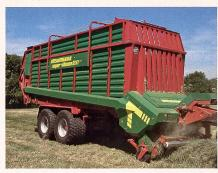
Die 10 mm starken Zinken des Rotors sind spiralförmig in fünf Zinkenreihen aufgesetzt und auf dem ganzen Durchmesser mit dem dickwandigen Zentralrohr verschweisst. Der Rotorantrieb über Duplexketten sorgt für eine gleichmässige Kraftübertragung. Das Achsaggregat besteht aus einer asymmetrischen Boogie-Pendelachse. Mit der maximalen Bereifung 710/40x22.5 verfügt der Ladewagen über ein Gesamtgewicht von 18 t. Er ist serienmässig mit einer ISOBUS-Bedienung ausgestattet.
