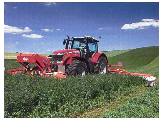
Bei der Baureihe 8600 von MF ist das Fronthubwerk in den taillierten Traktorrumpf integriert und erlaubt Hubkräfte bis 5 t.
