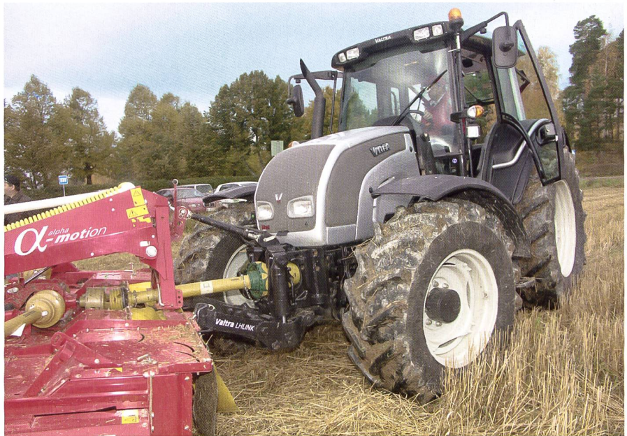
Das bei Kurvenfahrten nach innen mitschwenkende LHLINK-Fronthubwerk von Valtra kommt auch bei der neuen N-Serie zur Anwendung.
