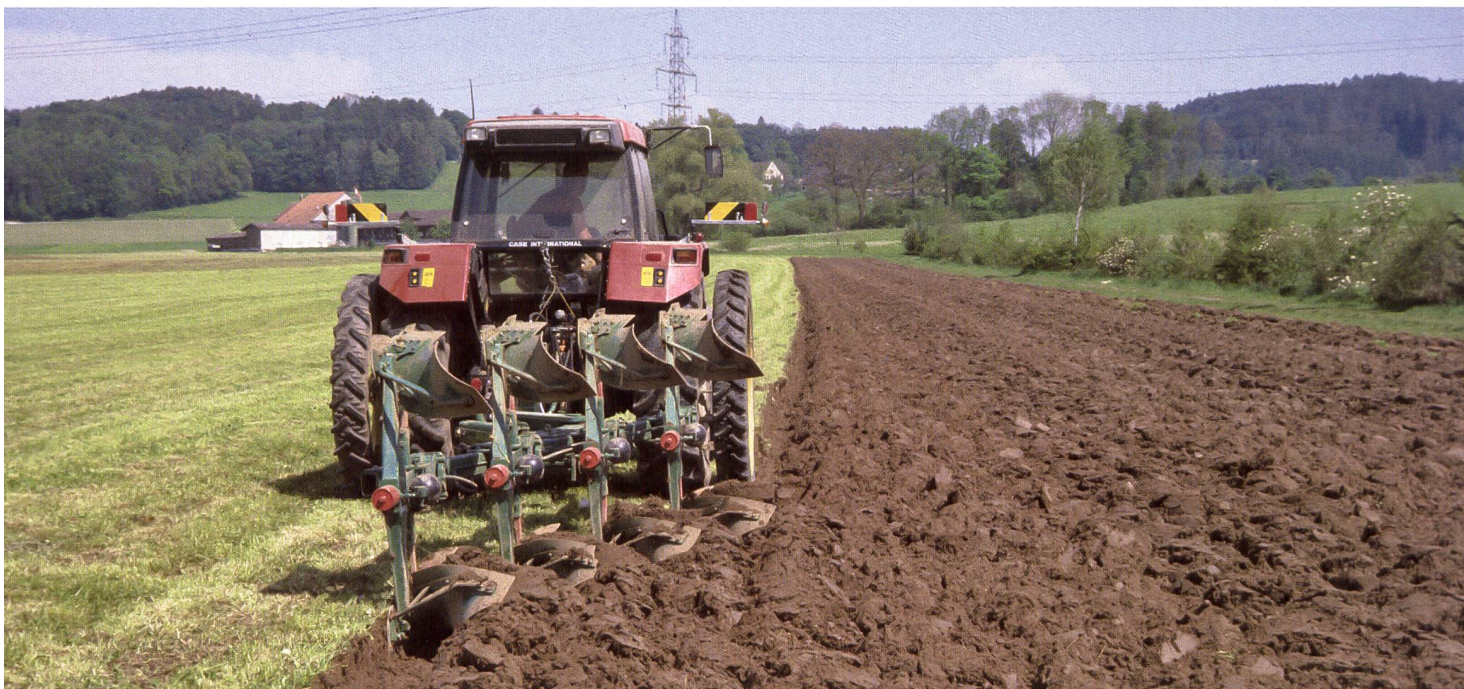
Flache Arbeitstiefen und gute Pflugeinstellung vermögen den Treibstoffbedarf beim Pflügen um über einen Drittel zu reduzieren.
