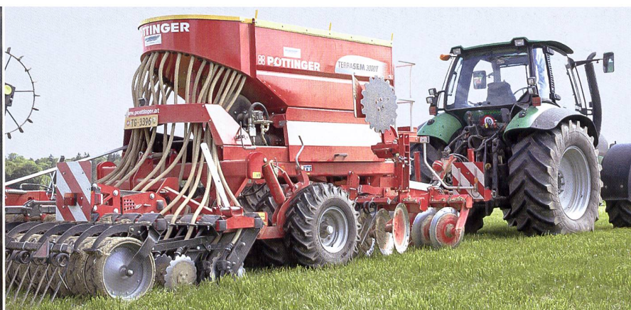
Mit schweren Scheibenscharsämaschinen kann auf intensive Bodenbearbeitung verzichtet werden. Gegenüber intensiver Bearbeitung lassen sich pro Hektare für die Bestellung über 30 Liter Diesel einsparen. (Fotos: Anken)
