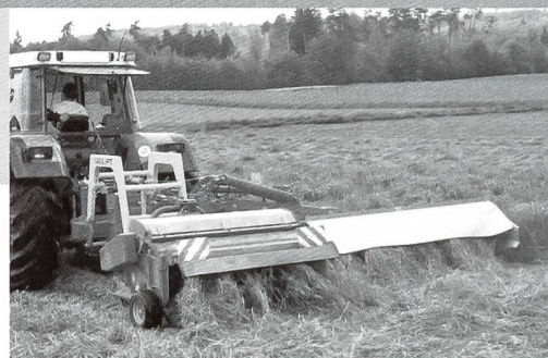
Kurmann HYDRO-LIFT 6,20 m mähen, aufbereiten, breit ablegen ohne das Futter überfahren zu müssen
