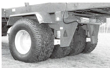
Kurmann 4-Rad-Fahrwerk 10 Tonnen Tragkraft bei 40 km/h gefederte Ausführung
