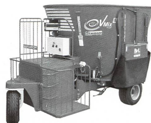
Kurmann Elektro-Fahrkopf zu BvL Futtermischwagen, Volumen 6,5 bis 14,0 m 3
