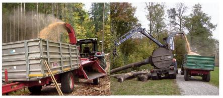
Abb. 12: Zapfwellenbetriebene Anbau- oder Anhängehacker eignen sich für den Einsatz im bäuerlichen Forst. Aufgebaute Grosshacker werden in der Regel überbetrieblich eingesetzt.
