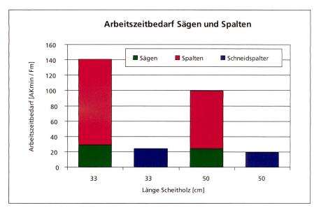
Abb. 10: Bei der Verarbeitung zu Scheitholz zeigen kombinierte Verfahren (Schneidspalter) deutliche Vorteile im Hinblick auf den Arbeitszeitbedarf.
