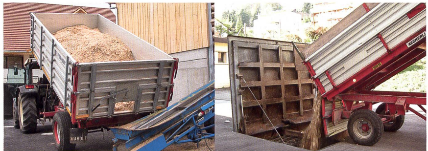
Abb. 14: Das Abladen der Hackschnitzel in einen unterirdischen Bunker bietet gegenüber dem Förderband arbeitswirtschaftliche Vorteile.
