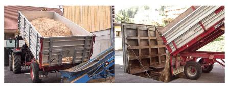
Abb. 14: Das Abladen der Hackschnitzel in einen unterirdischen Bunker bietet gegenüber dem Förderband arbeitswirtschaftliche Vorteile.
