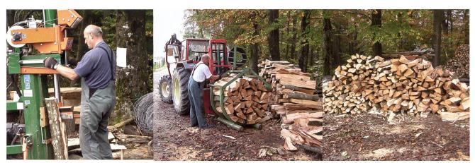
Abb. 6: Eine Aufarbeitung zu 1-m-Scheiten erfolgt in vielen Fällen bereits im Wald. Diese können lose gelagert oder zu Bündel weiter verarbeitet werden.
