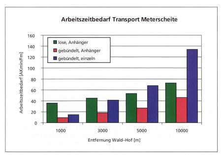
Abb. 8: Unterschiedliche Transportverfahren bedingen einen unterschiedlichen Arbeitszeitbedarf. Auch die Wald–Hof-Entfernung hat einen deutlichen Einfluss.
