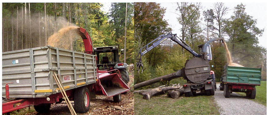
Abb. 12: Zapfwellenbetriebene Anbau- oder Anhängerhacker eignen sich für den Einsatz im bäuerlichen Forst. Aufgebaute Grosshacker werden in der Regel überbetrieblich eingesetzt.
