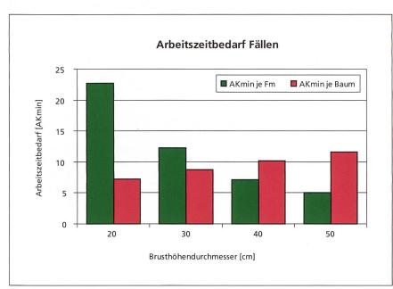
Abb. 3: Der Arbeitszeitbedarf für das Fällen ist je Festmeter mit steigendem Brusthöhendurchmesser rückläufig.
