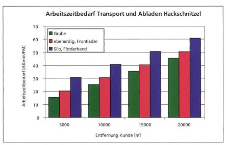
Abb. 13: Ausser der Entfernung hat auch die Form des Hackschnitzellagers Einfluss auf den Arbeitszeitbedarf bei der Anlieferung.
