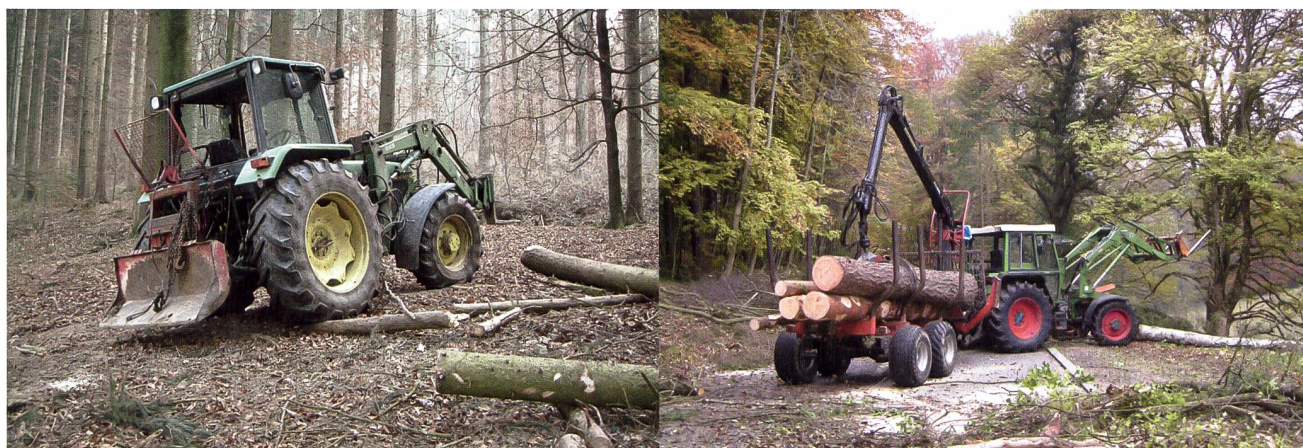
Abb. 4: Die Verbreitung der Seilwinde ist im bäuerlichen Forst nach wie vor sehr hoch. Teilweise kommen auch Forstanhänger mit Kran zum Einsatz.
