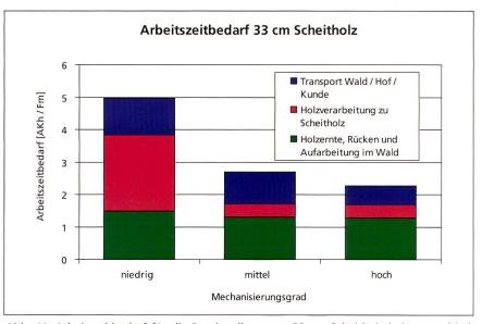
Abb. 11: Arbeitszeitbedarf für die Bereitstellung von 33-cm-Scheitholz bei unterschiedlichen Mechanisierungsstufen.
