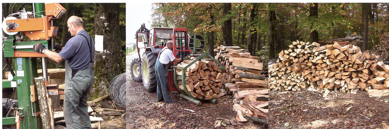
Abb. 6: Eine Aufarbeitung zu 1-m-Scheiten erfolgt in vielen Fällen bereits im Wald. Diese können lose gelagert oder zu Bündel weiterverarbeitet werden.
