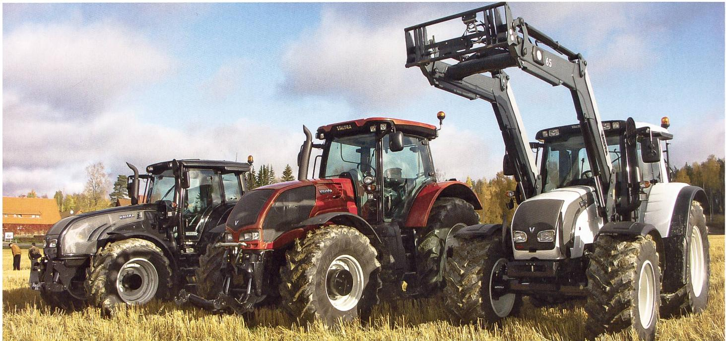
Valtra hat die Spitzenmodelle aus den N- und T-Serien einem Lifting unterzogen. Im Bild: links T 202, rechts N 142. Neue Motortechnik verleiht ihnen mehr Power und Durchzugsvermögen. Die Versu-Modelle sind mit einem Powershift-Getriebe ausgerüstet, die Direct-Modelle mit einem stufenlosen Getriebe. In der Mitte das 352er-Modell aus der neuen S-Serie mit einem Agco Stufenlos-Getriebe und AGCO Sisu Power SCR-Motor der neuesten Generation. (Fotos: Ueli Zweifel)
