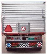
Die Heckmarkierungstafel ist in der linken Fahrzeughälfte auf einer Höhe von 250 bis 1500 mm zu befestigen. Sie darf weder zerschnitten noch überklebt (Höchstgeschwindigkeitszeichen) werden. Können bei besonderen Fahrzeugen, namentlich bei Arbeitsfahrzeugen, wegen ihrer Bauart oder Verwendung, die Anbringungsvorschriften nicht eingehalten werden, so ist die Heckmarkierungstafel möglichst nahe an der vorgeschriebenen Stelle anzubringen.
