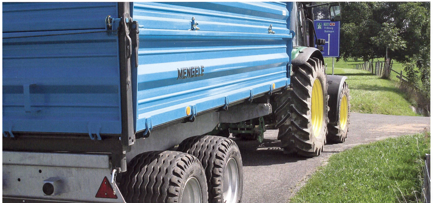
Je nach Abstand voneinander können Doppelachsen zwischen 11 und 20 t auf den Boden bringen. (Foto: Willi von Atzigen)
