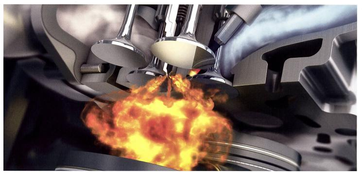
Die heterogene Verbrennung beim Dieselmotor führt zu einem Zielkonflikt bei der Absenkung der  $NO_{\chi^-}$  und Partikel-Emissionen. (Quelle: Bosch)
