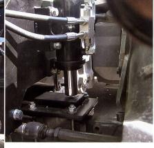
Die Hydraulikstempel ermöglichen, das «Einnicken» des Fahrzeugs kontrolliert zu begrenzen. Dies trägt zur besseren Stabilität beim mobilen Einsatz mit hochgehobenem und ausgeschwenktem Schneidgerät (z.B. an Waldrändern) bei.
