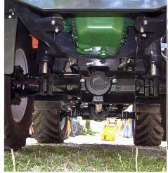
Seine grosse Standfestigkeit erreicht das Systemfahrzeug Evergreen durch die hydraulische Abstützung links und rechts, auf die zentral gelagerte Hinterachse.
