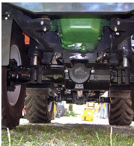
Seine grosse Standfestigkeit erreicht das Systemfahrzeug Evergreen durch die hydraulische Abstützung links und rechts, auf die zentral gelagerte Hinterachse.
