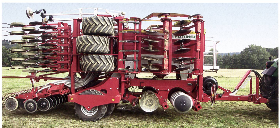
Terrasem C6: Das Fahrwerk ist durch eine kombinierte Packer- und Fahrwerkeinheit ersetzt. Als Vorlaufwerkzeug kommt entweder eine Spatenrollegge oder eine Kurzscheibenegge zum Einsatz. Die exakte Saatgutablage ist durch im Parallelogramm geführte Doppelscheibenschare mit nachlaufenden Tiefenführrollen gewährleistet.
