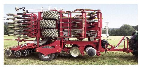
Terrasem C6: Das Fahrwerk ist durch eine kombinierte Packer- und Fahrwerkseinheit ersetzt. Als Vorlaufwerkzeug kommt entweder eine Spatenrollegge oder eine Kurzscheibenegge zum Einsatz. Die exakte Saatgutablage ist durch im Parallelogramm geführte Doppelscheibenschare mit nachlaufenden Tiefenführungsrollen gewährleistet.
