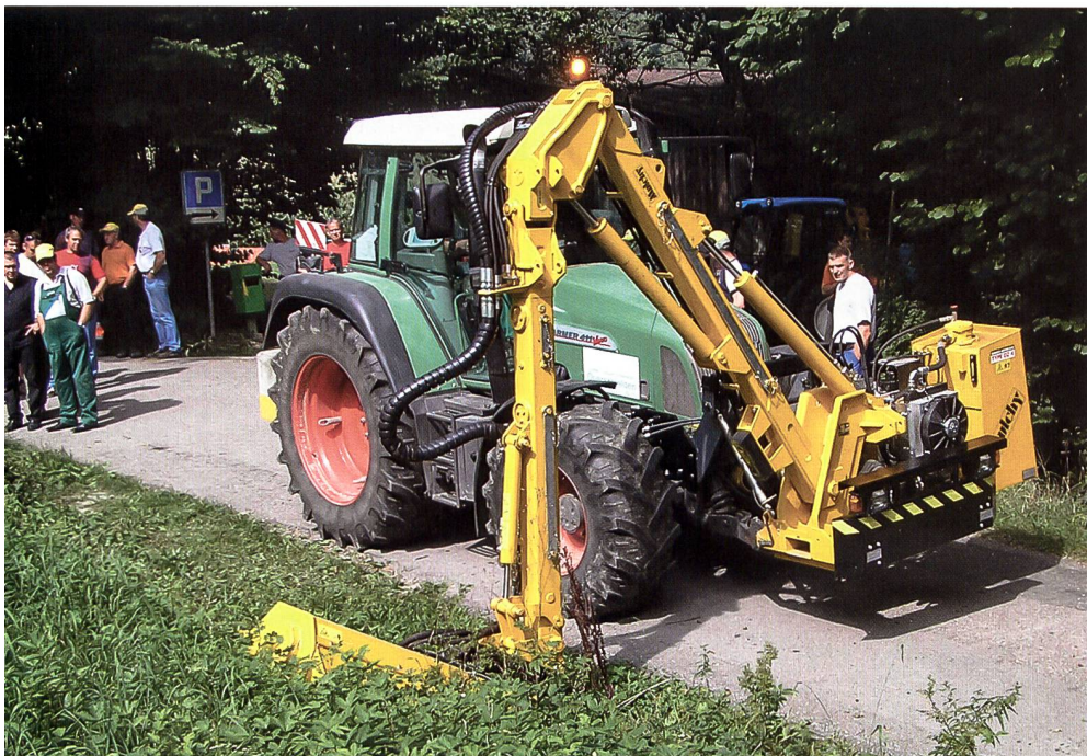
Traktor eines Lohnunternehmers, ausgerüstet mit Knickarmausleger am Schnellkuppler. Konstruktive und hydraulische Verstärkungen erhöhen die Tragkraft im mobilen Einsatz. (Bilder: Hansueli Schmid)
