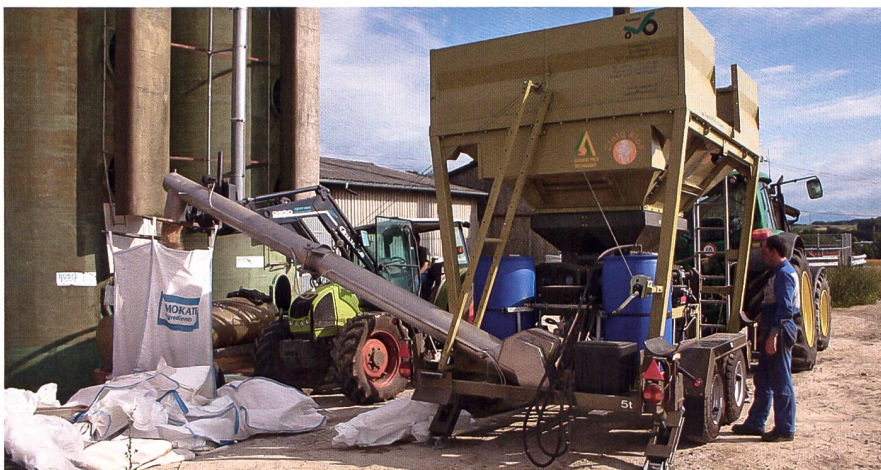
Wichtiger Betriebszweig des Lohnunternehmens: Mobile Quetschmaschinen für Feuchtmals unter Zugabe von Propionsäure. (Bild: Romon)
