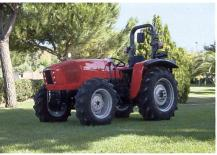
70-PS-Klasse (51,5 kW) entgegen. Ausgerüstet mit dem sparsamen SDF-3-Zylinder-Turbomotor, echten Vierradscheibenbremsen, dem extrem robusten 12/3-Gang-Getriebe und der praxisgerechten Hydraulikanlage bieten wir die beste Lösung für alle Kunden, die sich einen preiswerten Traktor mit äusserst tiefen Betriebskosten zulegen, dabei aber weder auf Leistung noch auf Zuverlässigkeit verzichten wollen.
