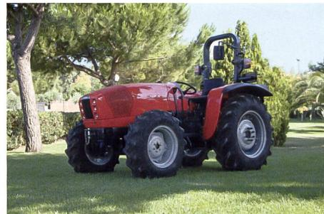
70-PS-Klasse (51,5 kW) entgegen. Ausgerüstet mit dem sparsamen SDF-3-Zylinder-Turbomotor, echten Vier-radscheibenbremsen, dem extrem robusten 12/3-Gang-Getriebe und der praxisgerechten Hydraulikanlage bieten wir die beste Lösung für alle Kunden, die sich einen preiswerten Traktor mit äusserst tiefen Betriebskosten zulegen, dabei aber weder auf Leistung noch auf Zuverlässigkeit verzichten wollen.
