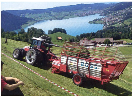
Ungelenkte Triebachse macht berggänglich. Doch können Kurvenfahrten gefährlich werden. (Bilder: Jules Furrer)
