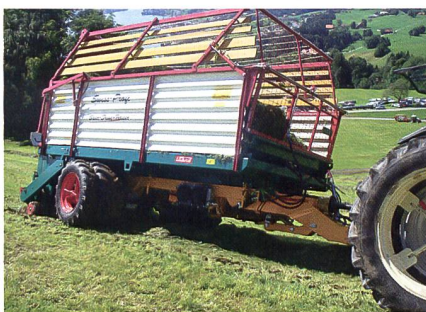
Die beiden Systeme mit gelenkter Triebachse: Steer-Drive-Trailer von Walter Rogenmoser, Unterägeri und...
