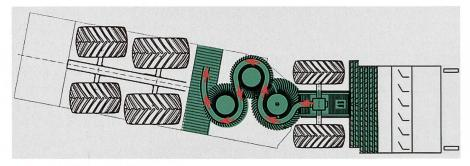
Abb. 1: Optimaler Rübenfluss am Beispiel Ropa «Euro-Tiger» – von der Aufnahme bis zur Entladung.
