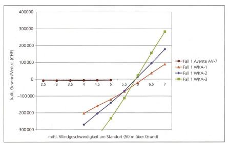
Abb. 5: Gewinn/Verlust in Abhängigkeit von verschiedenen Windgeschwindigkeiten
