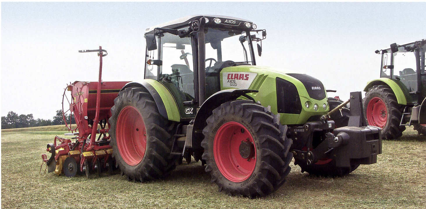
AXOS 340 CX, ausgerüstet mit standardmässiger Kabine aus dem Claas-Kabinenwerk in Le Mans (F). Mit weit vorne liegender Vorderachse erhält der 100-PS-Traktor seine kompakte Bauweise für einen polyvalenten Einsatz.
