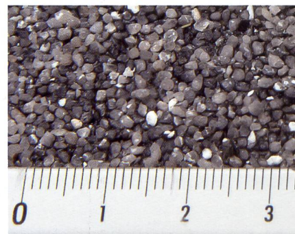
Abb. 2: Eine optimierte Oberflächenbearbeitung mit rundkörnigen Sanden soll zu starken Klauenabrieb verhindern und eine hohe Rutschfestigkeit sicherstellen.
