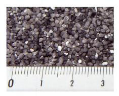
Abb. 2: Eine optimierte Oberflächenbearbeitung mit rundkörnigen Sanden soll zu starken Klauenabrieb verhindern und eine hohe Rutschfestigkeit sicherstellen.
