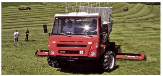
Die Besucher zum Staunen brachte ein Transporter Reform Muli mit dem Zusatzgerät Speed Rake von der Landmaschinenfirma Schuler Steinen. Dabei wird bis zu einer Arbeitsbreite von sechs Meter das Schwaden und Laden in einem Arbeitsgang erledigt.
