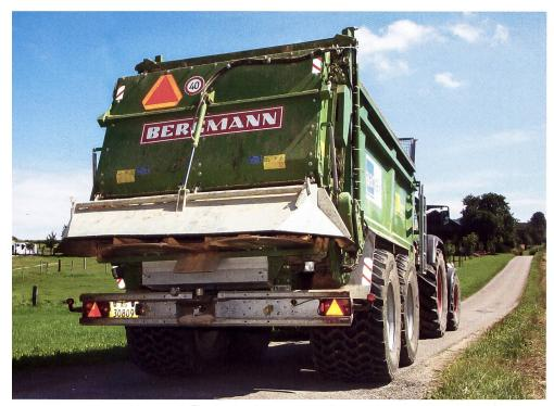
Transportanhänger mit Überbreite als Ausnahmefahrzeug eingelöst (Bild: Ueli Zweifel).
