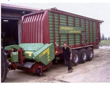
Mit dem Tridem-Fahrwerk ist es möglich, das Fahrzeug mit einem zulässigen Gesamtgewicht von 30t zuzulassen. Dieses wird dem enormen Ladevolumen gerecht. So wird das Fahrzeug, auch wenn es zum Häckseln von Mais eingesetzt wird, nicht überladen.
