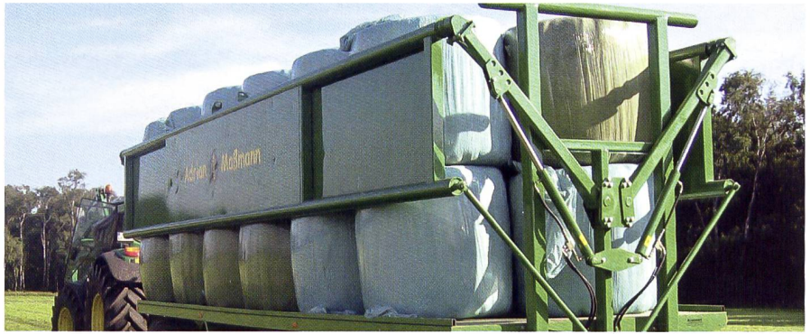
Hydraulisch verstellbare Seitengatter: schnell und teuer
