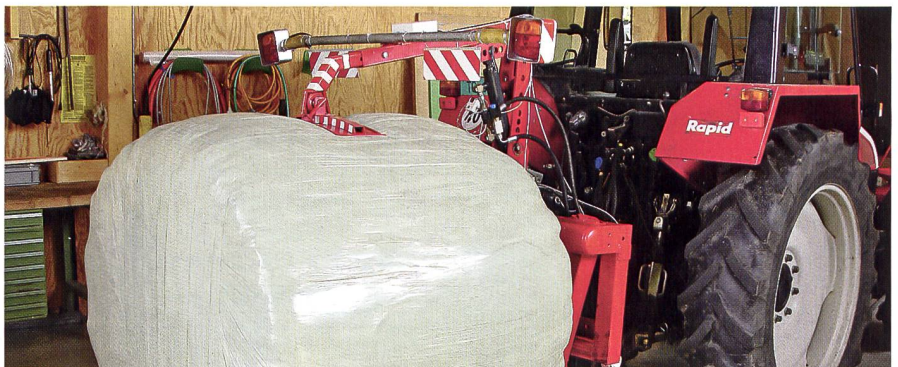
Ballengabel mit hydraulischem Arm für legalen Transport
