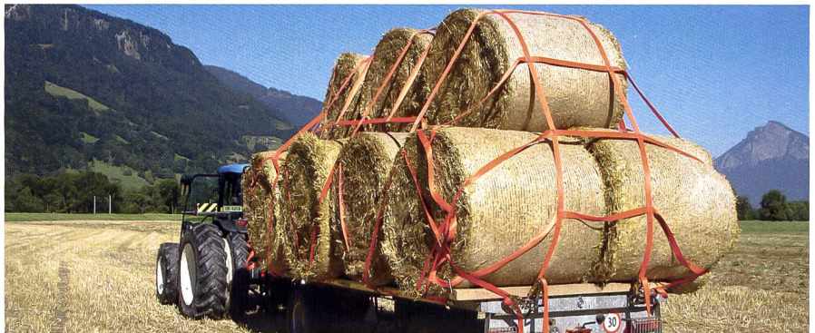
Netz aus Spanngurten: Kein Entkommen für Ballen
