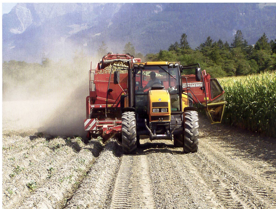
Ein Kartoffelvollernter nimmt pro Hektare ca. 1000 Tonnen Erde, Beimengen und Kartoffeln auf. Bei trockenen Erntebedingungen kann es zu einer erheblichen Staubentwicklung kommen. (Foto: R. Hunger)
