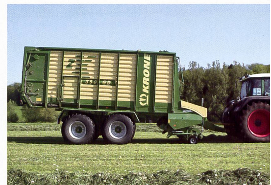
Lade- und Häckselwagen in einem (Foto: zvg)
