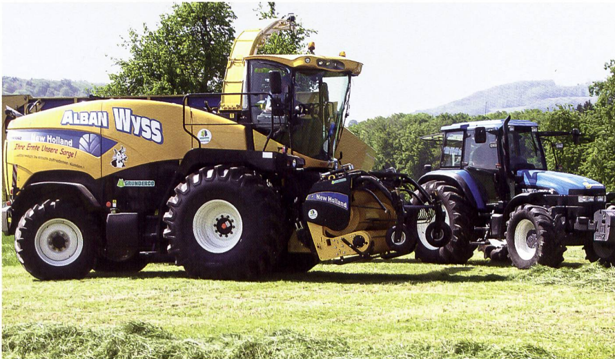
FR 9060 zum ersten Mal im Einsatz. Seine Kabine bietet eine optimale Rundumsicht, z. B. auf das Auswurfrohr, das um 210° gewendet werden kann. Der Lärmpegel in der Kabine beträgt bescheidene 77 db(A). (Fotos: Zw)
