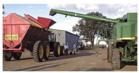
Sämtliche Arbeiten erfolgen bei CTF immer von permanenten Fahrgassen aus. Dazu werden in Australien die Abtankrohre der Mähdrescher verlängert und Überladewagen entsprechend angepasst.
