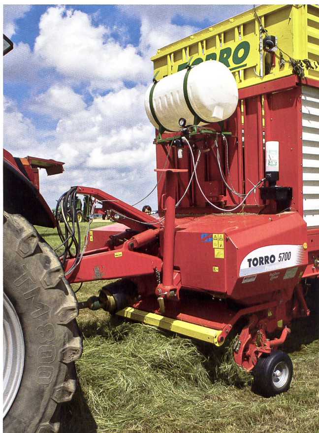
Mit Hilfe von Dosiergeräten lassen sich die Siliermittel homogen im Siliergut verteilen
