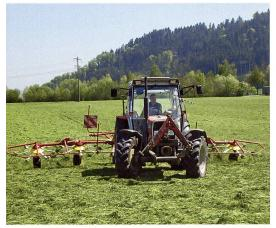
Mit dem acht Meter breiten Kreiselheuer ist die Flächenleistung gut. Bei grossem Arbeitsanfall wird auch noch die alte Maschine mit 6 m Arbeitsbreite eingesetzt. (Fotos: Bettina Nussbaumer)
