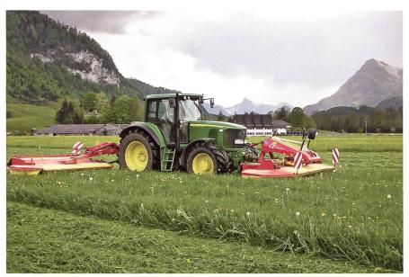
Das Mähwerk mit einer Arbeitsbreit von 6 m erlaubt eine hohe Flächenleistung und passt sich sehr gut an Bodenunebenheiten an.
