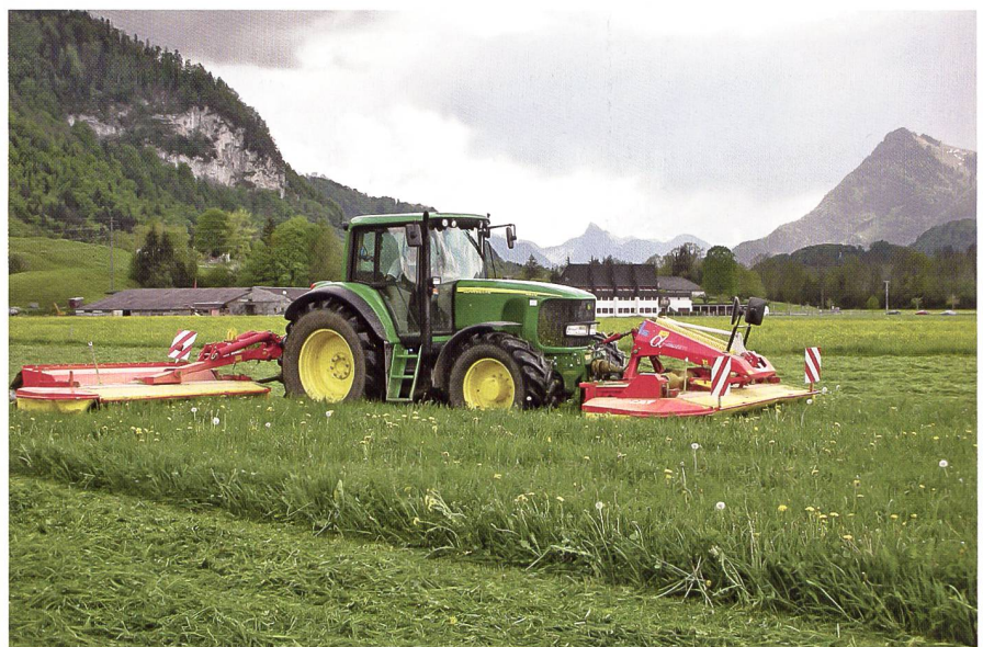
Das Mähwerk mit einer Arbeitsbreite von 6 m erlaubt eine hohe Flächenleistung und passt sich sehr gut an Bodenunebenheiten an.
