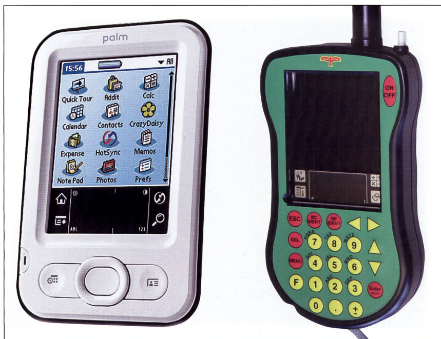
Abb. 5: Links einfacher PDA von Palm, rechts robuster PDA Milan MPX von Mannebeck mit integrierten Lesern für elektronische Ohrmarken und Barcodes.
