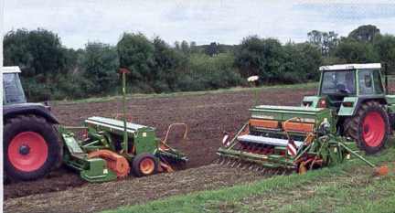
D9 Anbau- und AD3-Aufbausämaschinen verfügen über das neue mechanische Dosiersystem. (Foto: zvg)
