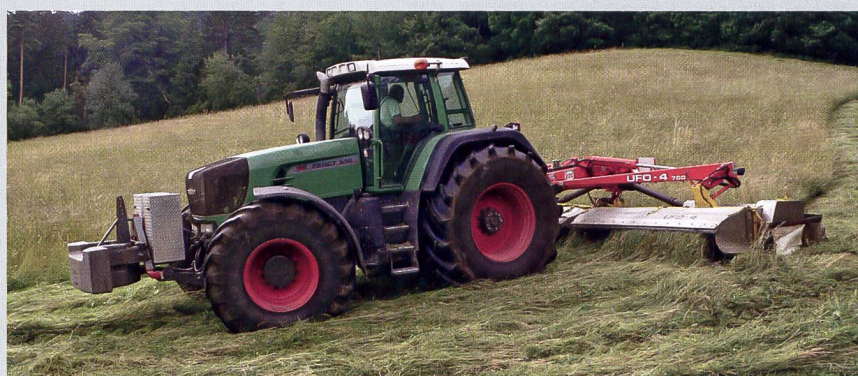
Montiert an der Heckhydraulik und pilotiert von der Rückfahrvorrichtung aus, ist die Schnittleistung des italienischen Mähwerks R.O.C. UFO 4 extrem gross. (Photo: Fabien Petermann)
