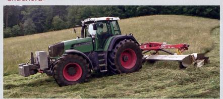
Montiert an der Heckhydraulik und pilotiert von der Rückfahrvorrichtung aus, ist die Schnittleistung des italienischen Mähwerks R.O.C. UFO 4 extrem gross.(Photo: Fabien Petermann)
