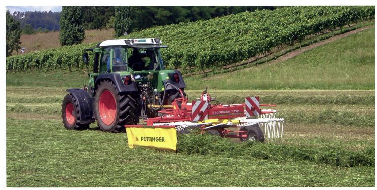
Faustregel für sparsames Fahren: Den Gang so wählen, dass der Motor bei 70 Prozent der Nennleistung und 70 Prozent der Nenndrehzahl läuft.
