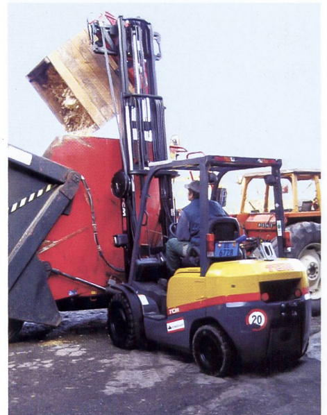
Ausschütthöhen mit Paloxen bis 4 m
