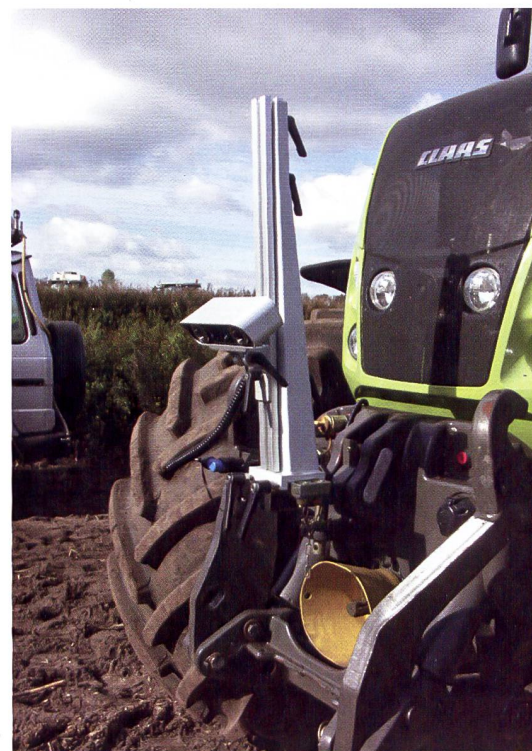
Im Gegensatz zu einfachen Kamerasystemen, die nur Konturen und Farben erkennen, erfasst das Lenksystem EYE-DRIVE von AGROCOM ( www.agrocom.com ) mittels zweier Kameras auch die dritte, räumliche Dimension.
