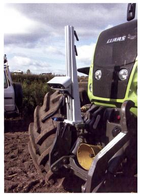
Im Gegensatz zu einfachen Kamerasystemen, die nur Konturen und Farben erkennen, erfasst das Lenksystem EYE-DRIVE von AGROCOM (www.agrocom. com) mittels zweier Kameras auch die dritte, räumliche Dimension.
