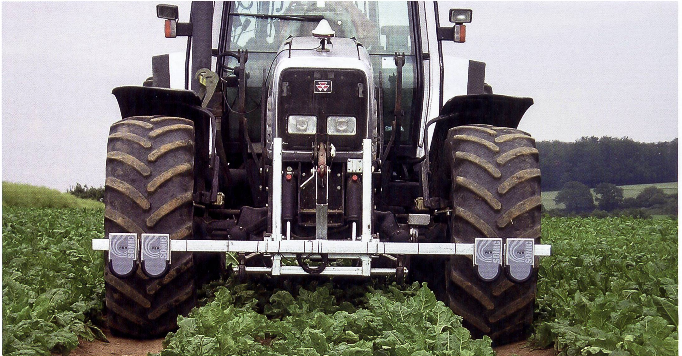
Lenkung per Ultraschall: Das PSR-Sonic von Reichardt detektiert per Ultraschall Furchen, Fahrgassen, Schwaden oder andere Längsstrukturen (Bild Reichardt, www.reichardt.org ).
