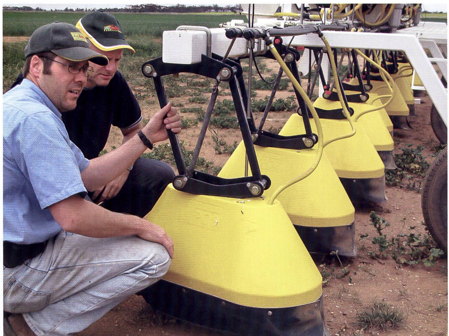
Applikation von Glyphosat zwischen den Reihen mittels GPS-Lenkung und Spritzhauben in Australien. Fahrgeschwindigkeiten bis 18 km/h sind möglich ( www.postlethwaite.com.au ).
