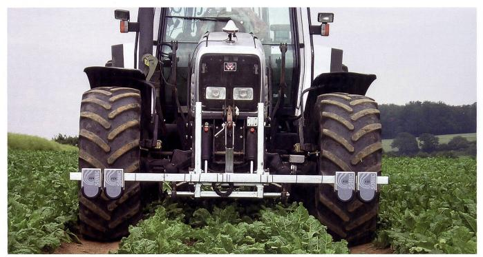
Lenkung per Ultraschall: Das PSR-Sonic von Reichhardt detektiert per Ultraschall Furchen, Fahrgassen, Schwaden oder andere Längsstrukturen (Bild Reichhardt, www.reichhardt.org).
