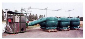
Abb. 4: Belüftungsanlage Tecnolam für Rundballen hat einen höheren Investitionsbedarf und beansprucht einen geringeren Energieaufwand.
