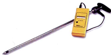
Abb. 2: Geeignete Messinstrumente erlauben es, den Feuchtegehalt in den Ballen direkt auf dem Feld zu bestimmen.
