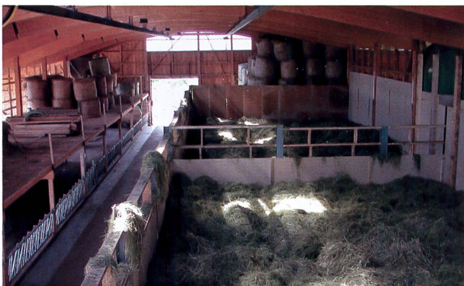
Abb. 5. Bergeräume für loses Futter brauchen mehr Lagervolumen als jene für Ballen; sie benötigen zudem Einrichtungen für den Futterumschlag.
