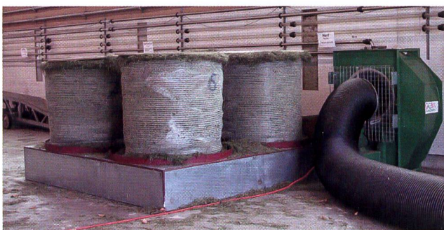
Abb. 3: Die Belüftungsanlage GEBA für Rundballen hat einen geringen Investitionsbedarf, beansprucht jedoch viel Energie.
