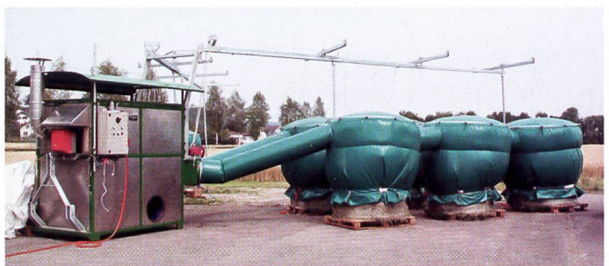
Abb. 4: Belüftungsanlage Tecnomat für Rundballen hat einen höheren Investitionsbedarf und beansprucht einen geringeren Energieaufwand.
