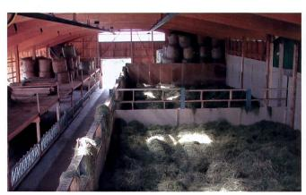
Abb. 5. Bergeräume für loses Futter brauchen mehr Lagervolumen als jene für Ballen; sie benötigen zudem Einrichtungen für den Futterumschlag.
