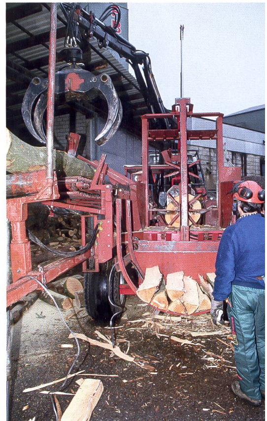
Aufwendige Vollmechanisierung der Stückholzaufbereitung
