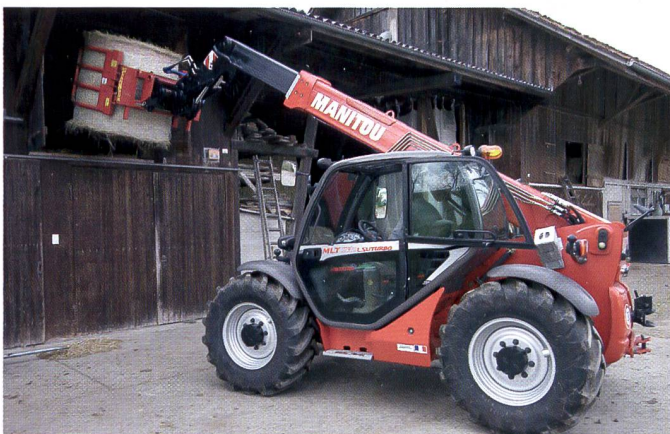
Mit der Rundballenzange schafft der Manitou MLT 731 T LSU mit Leichtigkeit die schwersten Heu- und Siloballen und platziert sie an den gewünschten Ort.
