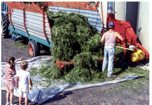
Auch die einfache Eigenmechanisierung mit Ladwagen, Förderband und Gebläse funktioniert und ist gang und gäbe. Der Kostenvorteil wird durch Manneskraft und relativ geringe Leistung erkauft. (Foto: Paul Müri)
