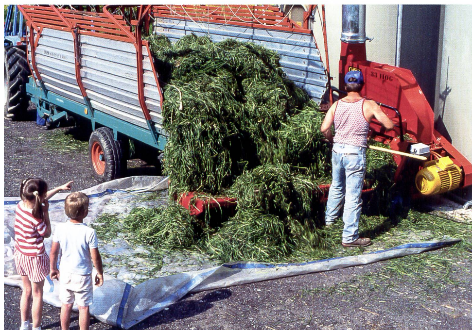
Auch die einfache Eigenmechanisierung mit Ladewagen, Förderband und Gebläse funktioniert und ist gang und gäbe. Der Kostenvorteil wird durch Manneskraft und relativ geringe Leistung erkaufte. (Foto: Paul Müri)
