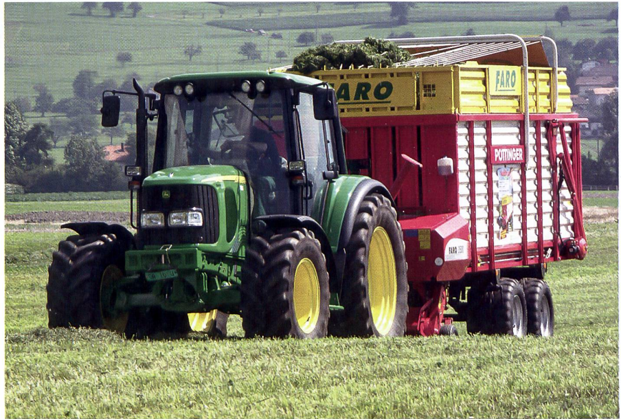
Moderne Kurzschnittladewagen sind in der Lage das Siliergut ähnlich fein aufzubereiten wie Feldhäcksler. Sie trumpfen namentlich bei kurzen Transportdistanzen auf, wenn sich eine personal- und kapitalintensive Häckslerkette umgehen lässt. (Bild Ueli Zweifel)
