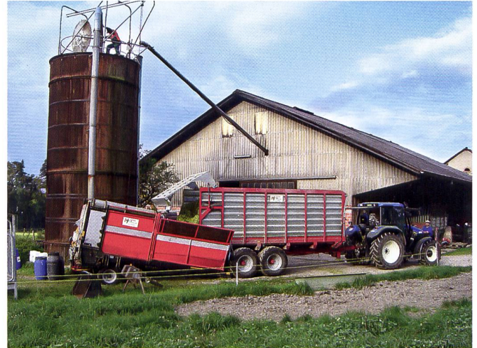
Die Lösung des Lohnunternehmers: Feldhäcksler, Silierwagen (Foto: Zw), Dosieraggregat und Wurfgebläse (Foto: Hirter/Tschanz, Safenwil AG).
