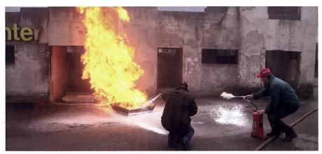
Löschen mit Schaumlöscher (links) und Staublöscher (rechts).
