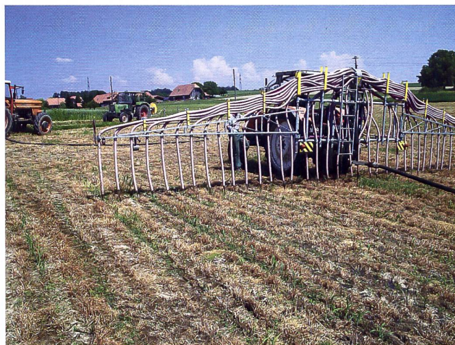
Abb. 5: Mit Schleppschlauchverteilern wird die Gülle exakt und verlustarm im Mais ausgebracht (Foto: M. Häberli).
