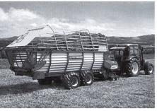
ausgezeichnetes, seitlich ausschwenkbares Schneidwerk -Easy Move für bequeme, einfache Wartung. Mit der Komfortbedienung sind sämtliche Ladewagenfunktionen steuerbar. Die Pöttinger-Ladewagen sind einschliesslich der Euroboss-Serie auch ISO-BUS-fähig.
