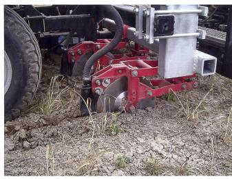
Abb. 3: Düngerschar (Semeato) für die Unterfussdüngung (Eigenbau-Direktsaatmaschine von ART).
