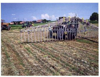
Abb. 5: Mit Schleppschlauchverteilern wird die Gülle exakt und verlustarm im Mais ausgebracht (Foto: M. Häberli).
