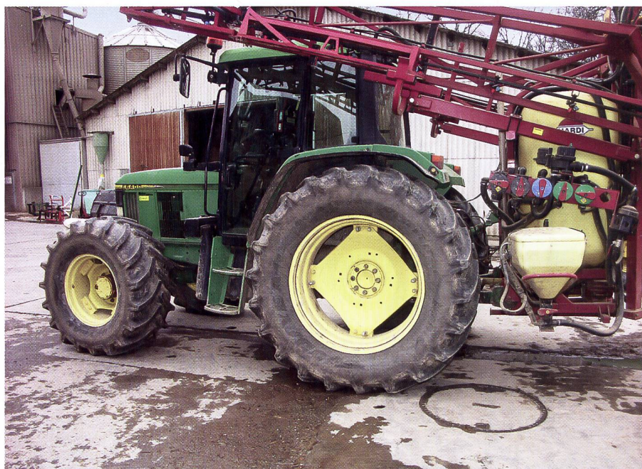
Breitbereifung für eine hohe Tragkraft und eine tiefe (spezifische) Bodenbelastung. Später im Jahr wird die Pflegebereifung für die Fahrt in den Fahrspuren montiert. (Bilder: Ueli Zweifel)
