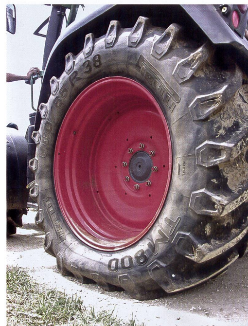
Der Aufbau der robusten Radialkarkasse macht es möglich. Starke Einfederung dank tiefem Luftdruck für eine grosse Aufstandsfläche.
