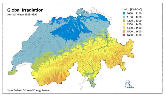
Abb. 3: Globale Solarstrahlung in der Schweiz, horizontal (Quelle: Kartengrundlagen Landestopografie, Bern; Strahlungsdaten: Meteonorm)
