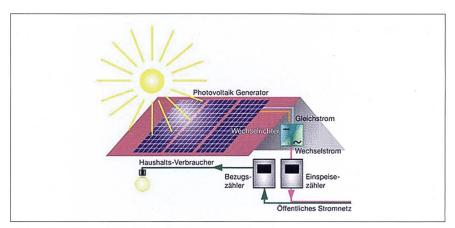
Abb. 2: Funktionsschema einer PV-Anlage im Netzverbund.
