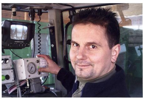
Mit einer Luftdruckregulierungsanlage spart Oskar Schenk auf der Strasse Diesel und schont im Acker den Boden.
