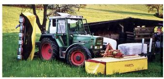
Mit der Mähwerkskombination samt Walzenaufbereiter erzielt Hanspeter Neukomm trotz reduzierter Fahrgeschwindigkeit eine hohe Leistung. (Foto: Hanspeter Neukomm)
