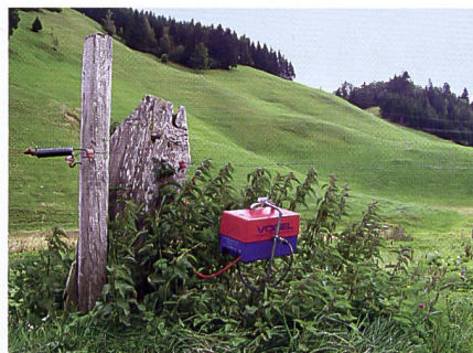
Bei der Standortwahl für Batteriegeräte muss eine gute Erdung im Vordergrund stehen.
