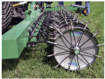
Injektorrad für die punktförmige Ammonium-Applikation bei Engreihenkulturen und Grünland. Die sternförmigen Injektornippel sind am Ende verschlossen. Der Flüssigkeitsaustritt erfolgt durch seitliche Öffnungen zum Zeitpunkt, in dem die Nippel in den Boden einstechen. Durch Pendelaufhängung und Federbelastung der Einzelaggregate wird eine gleichmässige Tiefenführung erreicht.
