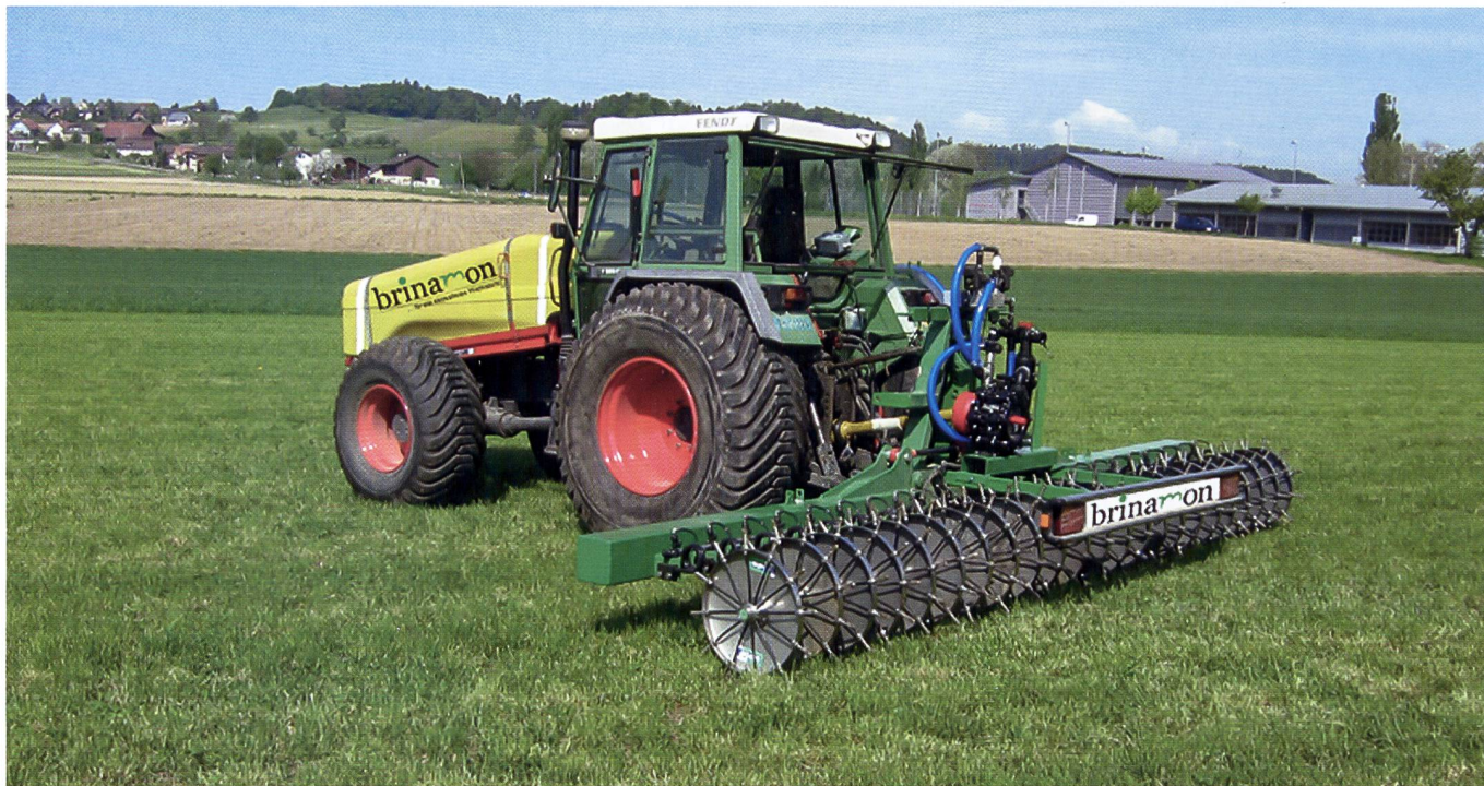
Radinjektor mit Traktor und Düngertank.
