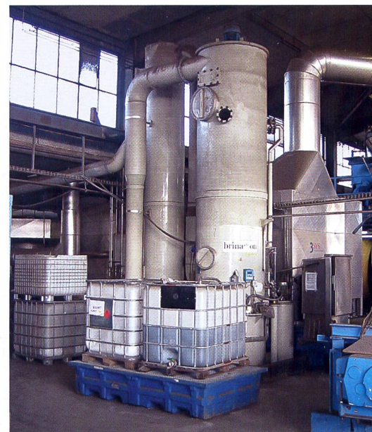
Ammoniakstrippanlage für die Herstellung von Ammoniumsulfatlösung (Brinamon). Das aus einem Fabrikationsprozess anfallende Ammonium wird im Luftstrom als Ammoniak ausgetrieben und im nachfolgenden Prozess ausgewaschen und an Säure gebunden.
