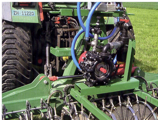
Die Membranpumpe und die Regelventile des Injektorgerätes werden durch einen Mikroprozessor gesteuert. Die gewünschte Applikationsmenge kann so unabhängig von der Arbeitsgeschwindigkeit eingehalten werden. Die Schaummarkierung an den Radträgerenden ermöglicht bei allen Feldverhältnissen ein exaktes Anschlussfahren.
