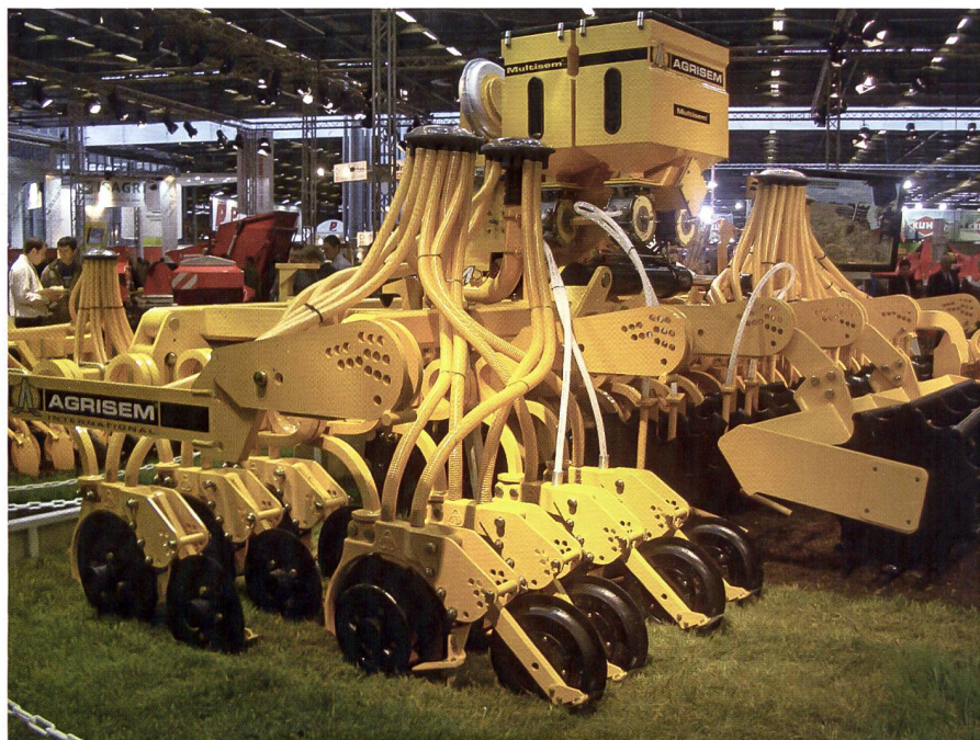
Abb. 2: Demonstrationssämaschine «Direct-O-Sem» von Agrisem an der SIMA 2007, ausgerüstet mit zentraler, pneumatischer Saatgutdosierung (weisse Schläuche).
