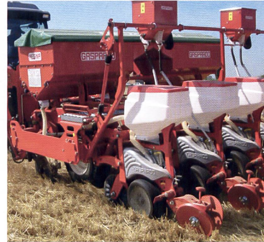
Abb. 3: Gezogene Maissämaschine Gaspardo «Regina» für Direktsaat (Werksfoto).
