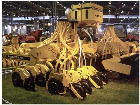
Abb. 2: Demonstrationssämaschine \( \text{Direct-O-Sem von Agrisem an der SIMA 2007, ausgerüstet mit zentraler, pneumatischer Saatgutdosierung (weisse Schläuche).}\)
