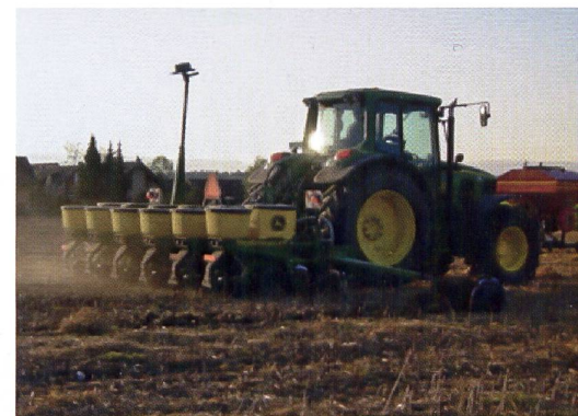
Abb. 4: 6-reihige Direktsaatmaschine mit Düngertank an der Fronthydraulik und hydraulischer Gewichtsübertragung von der Hinterachse des Traktors auf die Säschare zur Erhöhung des Schardrucks (Foto: H.P. Lauper).
