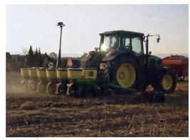
Abb. 4: 6-reihige Direktsaatmaschine mit Düngertank an der Fronthydraulik und hydraulischer Gewichtsübertragung von der Hinterachse des Traktors auf die Säschare zur Erhöhung des Schardrucks (Foto: H.P. Lauper).
