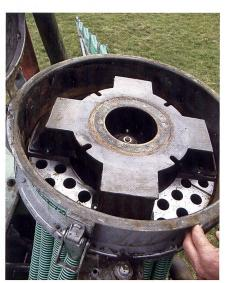
Scharfe Messer im Verteilkopf für den störungsfreien Betrieb.
