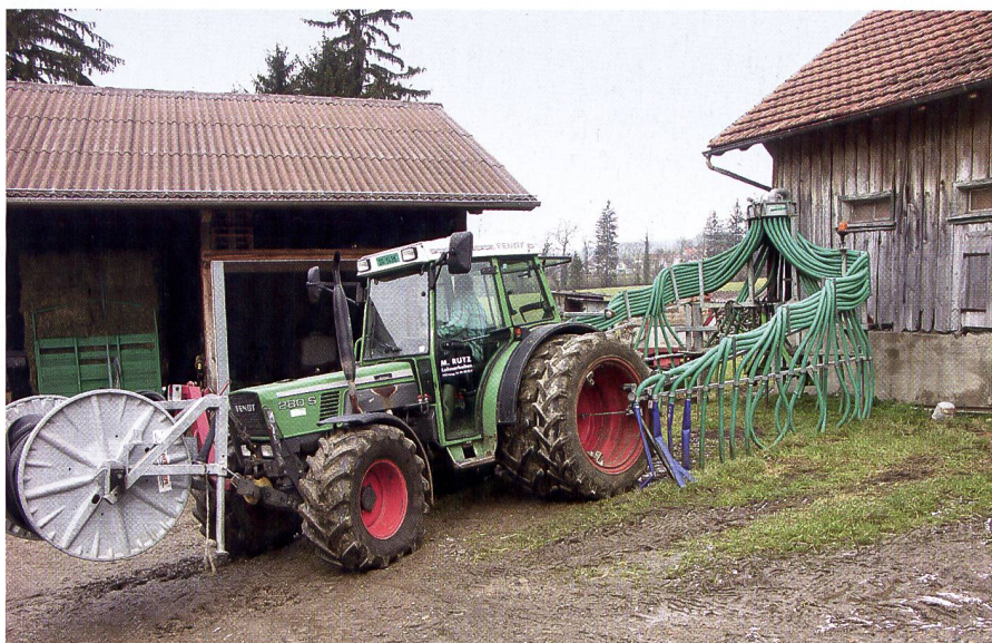
Die Investition in eine neue leistungsfähiger Gerätetechnik zieht in manchen Fällen auch eine stärkere Motorisierung nach sich. Mit dem neuen Schleppschlauchverteiler wechselte Marcel Rutz von einem Farmer 240 S auf das Modell 280 S.
