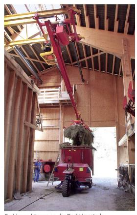
Drehkrane hängen an der Dachkkonstruktion und belasten diese unterschiedlich stark. Die auf dem Kran mitfahrende Bedienperson hat sowohl zur Entnahme, wie auch zur Übergabe in den Mischwagen eine gute Übersicht. (Bild: Patrizia Wolf)
