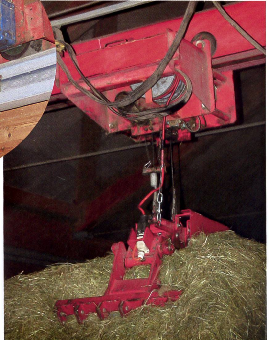
Der am Seil hängende Greifer benötigt eine Stromversorgung und beinhaltet eine Hydraulikpumpe samt Antriebsmotor und Ölvorrat. Brückenkrananlagen mit einem Träger können, bedingt durch ihre Konstruktion, den Lagerraum schlechter ausnützen. (Bild: Ruedi Hunger)
