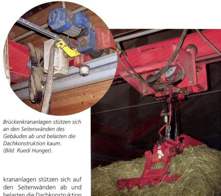
Der am Seil hängende Greifer benötigt eine Stromversorgung und beinhaltet eine Hydraulikpumpe samt Antriebsmotor und Ölvorrat. Brückenkrananlagen mit einem Träger können, bedingt durch ihre Konstruktion, den Lagerraum schlechter
