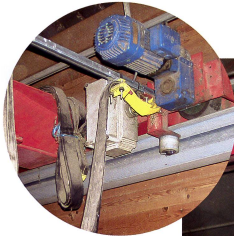
Brückenkrananlagen stützen sich an den Seitenwänden des Gebäudes ab und belasten die Dachkonstruktion kaum. (Bild: Ruedi Hunger).
