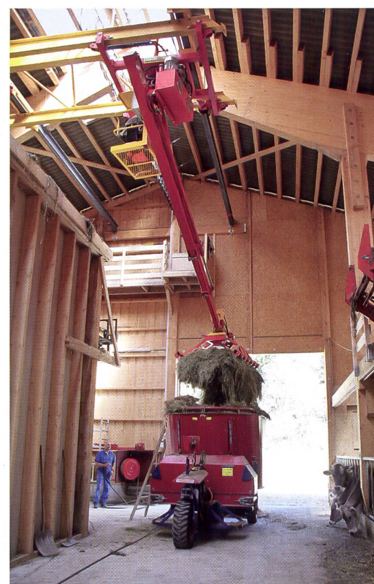
Drehkrane hängen an der Dachkonstruktion und belasten diese unterschiedlich stark. Die auf dem Kran mitfahrende Bedienerperson hat sowohl zur Entnahme, wie auch zur Übergabe in den Mischwagen eine gute Übersicht. (Bild: Patrizia Wolf)
