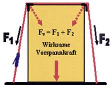
Die Vorspannkraft (F<sub>v</sub>) des Zurrgurtes resultiert aus den beiden Kräften F1 und F2. Diese sind aber meistens nicht gleich gross, was zu Seitenzug führt.
