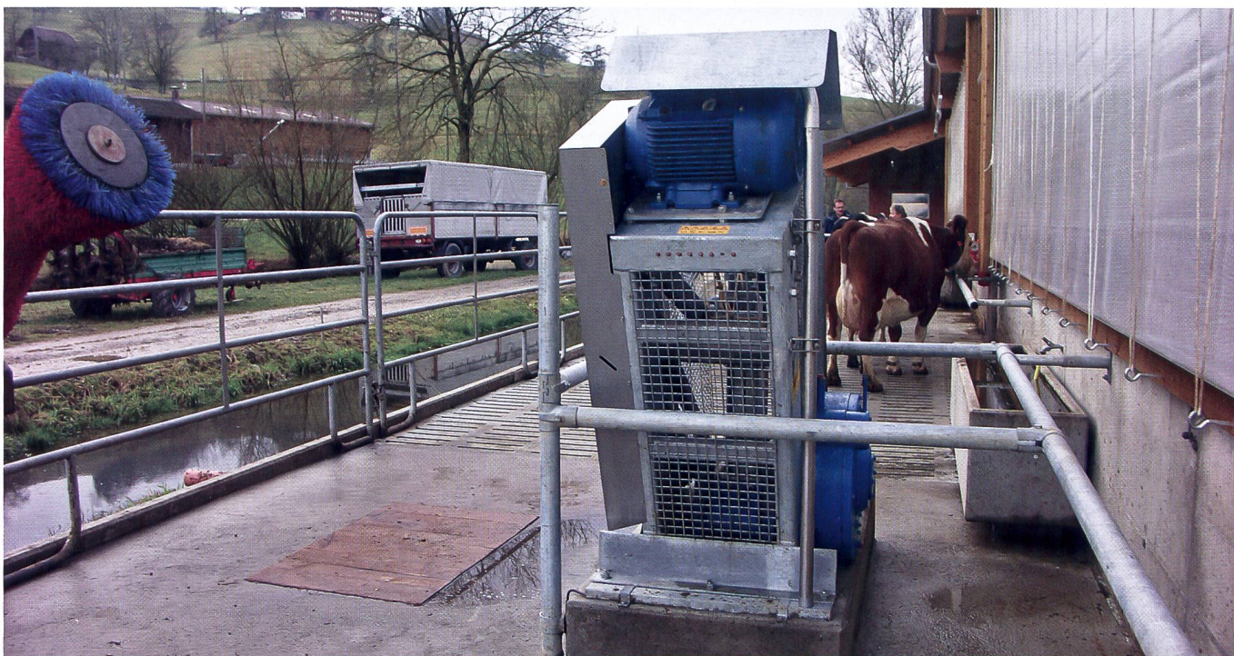
Schaufelrührwerk Fankhauser: Die Schöpfbewegung, die die Gülle durch eine wellenförmige Bewegung in Zirkulation versetzt, bedingt eine sehr massive und robuste Konstruktion (Bild: Ueli Zweifel).
