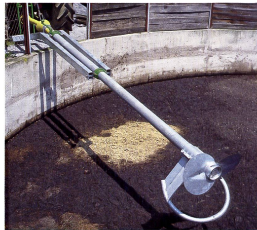
Für den variablen und überbetrieblichen Einsatz: Gülle-mixer an der Traktorhydraulik für grosse Leistungen (Werkphoto Bauer importiert durch AgriBuchs, SA Yverdon)
