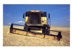
Der neue CSX 7060 Laterale verfügt über einen seitlichen Achs-Ausgleich von 18 Prozent. (Foto: zvg)
