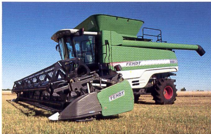
Dank hydrostatischem Antrieb dreht der Rotor im Mähdrescher konstant. (Foto: zvg)
