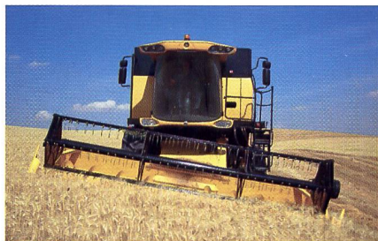
Der neue CSX 7060 Laterale verfügt über einen seitlichen Achs-Ausgleich von 18 Prozent. (Foto: zvg)
