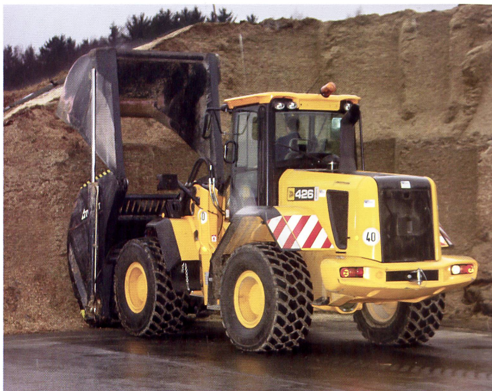
Modernste Technik auf dem Betrieb Probst mit spezieller Schneidschaufel zur Beschickung der Futtermischer auf den Fermentern
